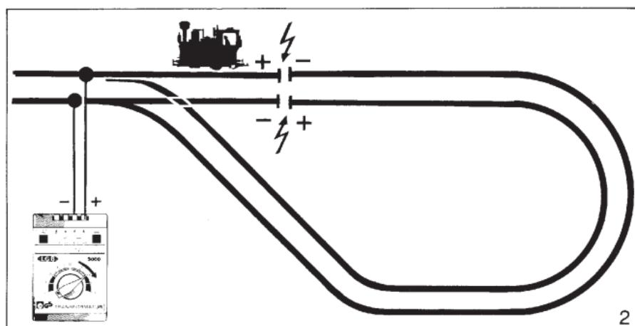
Der unbekümmerte Modelleisenbahner wird auf seiner Erstanlage mit Kehrschleife beim Einschalten des Fahrstromes feststellen, daß die Überstromsicherung des Fahrreglers in Funktion tritt. Die Gleisführung der Kehrschleife verursacht einen Kurzschluß.
