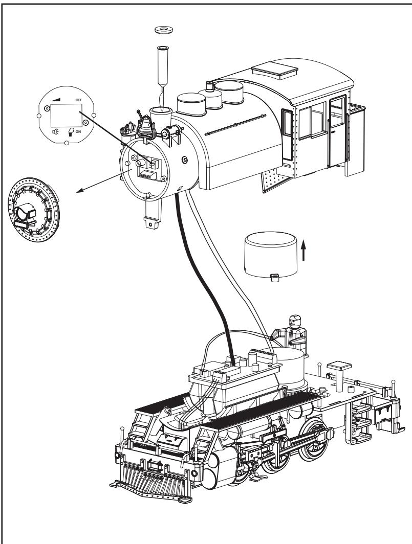
Die Lok ist bereits mit einem zuschaltbaren Dampfentwickler ausgestattet. Der Schalter befindet sich in der Rauchkammer. Nehmen Sie die Rauchkamertür ab. Schalten Sie den Dampfentwickler an (Schalterstellung unten) oder aus (Schalterstellung oben).
