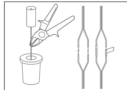
*Bild 2, 3 & 4, Austausch des Dampfentwicklers*
