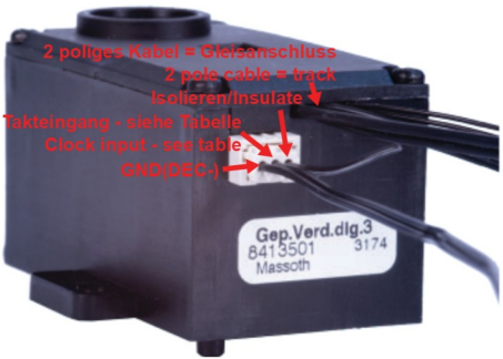
Abbildung 5: Anschluss mit Taktgebersimulation Illustration #5: Hook-Up with a pulse generator simulation
