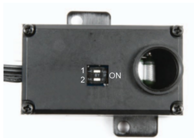
Abbildung 2: Betriebsartenschalter Illustration #2: Mode selector DIP-switches
