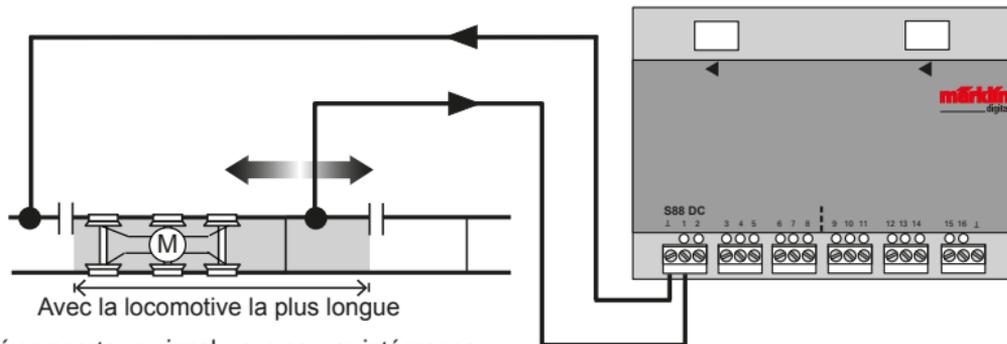
Si le tronçon de voie surveillé comporte un signal, vous pouvez intégrer ce tronçon de voie sans courant à la surveillance en dérivant l'isolation au moyen d'une résistance (1,5 k $\Omega$ ).
