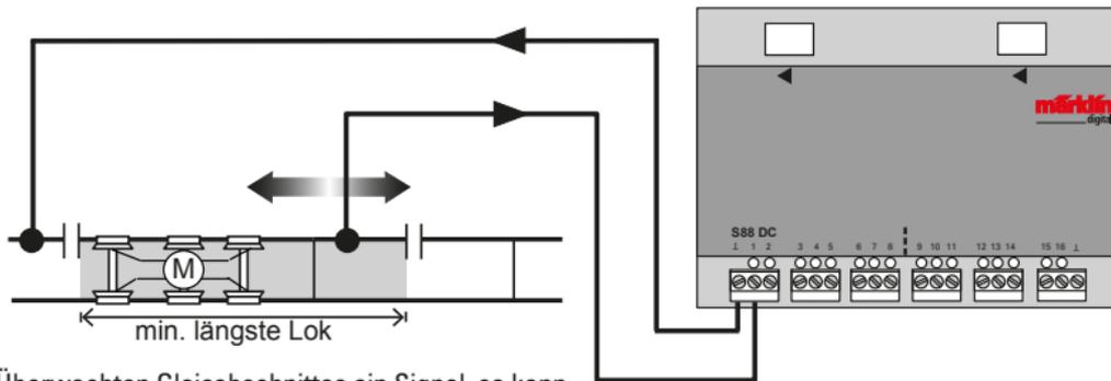
Befindet sich innerhalb des Überwachten Gleisabschnittes ein Signal, so kann dieser stromlose Gleisabschnitt durch Überbrückung der Isoierung mittels eines Widerstandes (1,5 k $\Omega$ ) in die Überwachung einbezogen werden.
