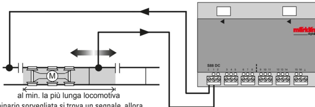
Se all'interno della tratta di binario sorvegliata si trova un segnale, allora questa sezione di binario senza corrente può venire inclusa nella sorveglianza mediante scavalcamento dell'isolamento con un ponticello per mezzo di una resistenza (1,5 k $\Omega$ ).
