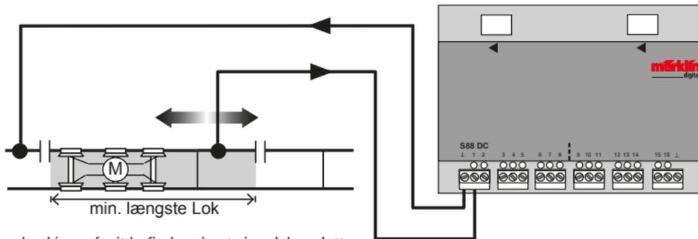
Hvis der indenfor det overvågede skinneafsnit befinder sig et signal, kan dette integreres i overvågningen ved hjælp af omløb af isoleringen ved hjælp af en modstand (1,5 k $\Omega$ ).
