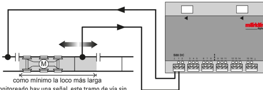
Si dentro del tramo de vía monitoreado hay una señal, este tramo de vía sin corriente puede integrarse en la función de monitoreo puenteando el aislamiento mediante una resistencia (1,5 k $\Omega$ ).
