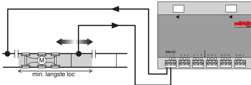
Indien er zich binnen een spoorsectie een stopsectie bevindt, dan kan deze door het overbruggen van de isolatie met een weerstand van 1,5 k $\Omega$  in de bewaking van de sectie opgenomen worden.
