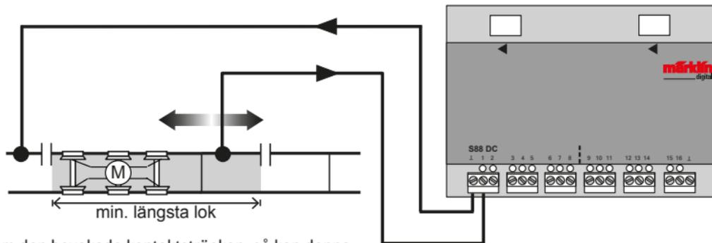
Om en signal är placerad inom den bevakade kontaktsträckan, så kan denna strömlösa spårsträcka inkluderas i den bevakade spårsträckan genom att överbrygga isoleringen med ett motstånd (1,5 k $\Omega$ ).
