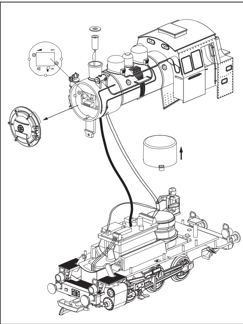
Die Lok ist bereits mit einem zuschaltbaren Dampfentwickler ausgestattet. Der Schalter befindet sich in der Rauchkammer. Nehmen Sie die Rauchkammertür ab. Schalten Sie den Dampfentwickler an (Schalterstellung unten) oder aus (Schalterstellung oben).
