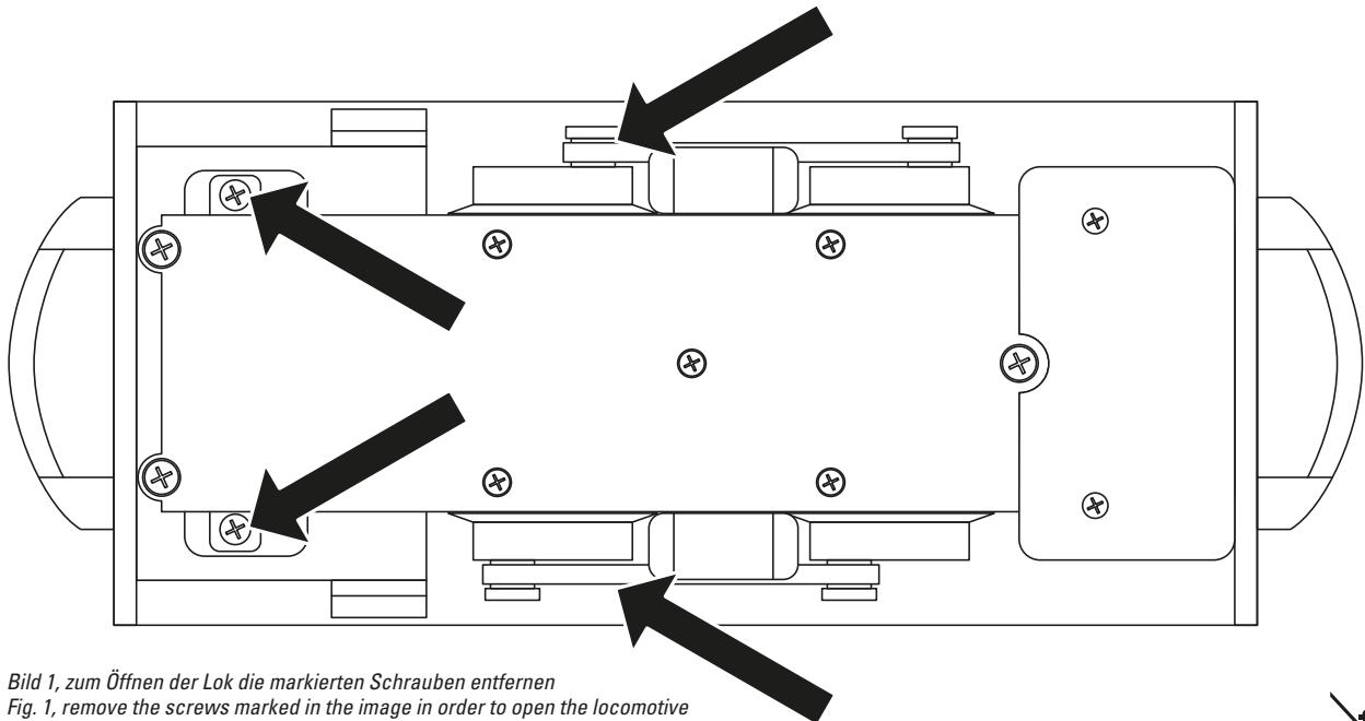
Bild 1, zum Öffnen der Lok die markierten Schrauben entfernen
