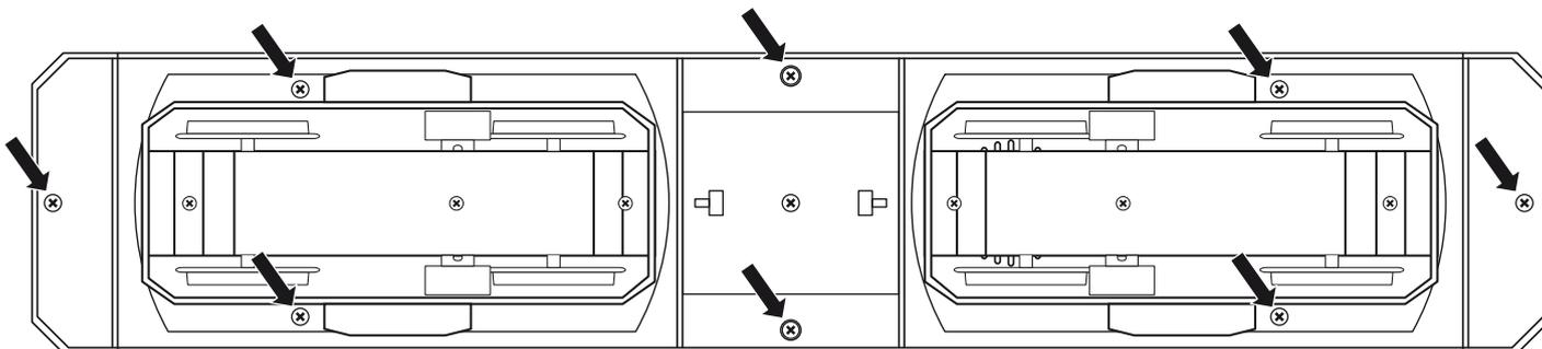
*Bild 6, zum Öffnen der Lok die markierten Schrauben entfernen*
