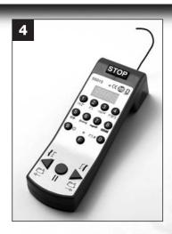
Vous pouvez mettre la télécommande hors tension après utilisation en appuyant simultanément sur les boutons F et 0.
