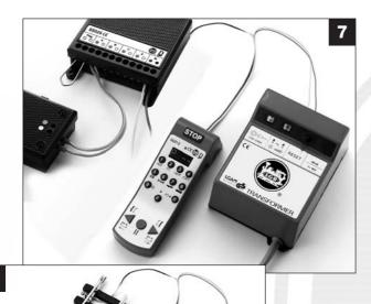
La programmation se fait de la même façon pour tous les décodeurs. La fiche d'instructions du décodeur indique les registres (CV) à programmer pour modifier les paramètres du décodeur. Par exemple, la programmation de l'adresse du décodeur se fait par CV1:
