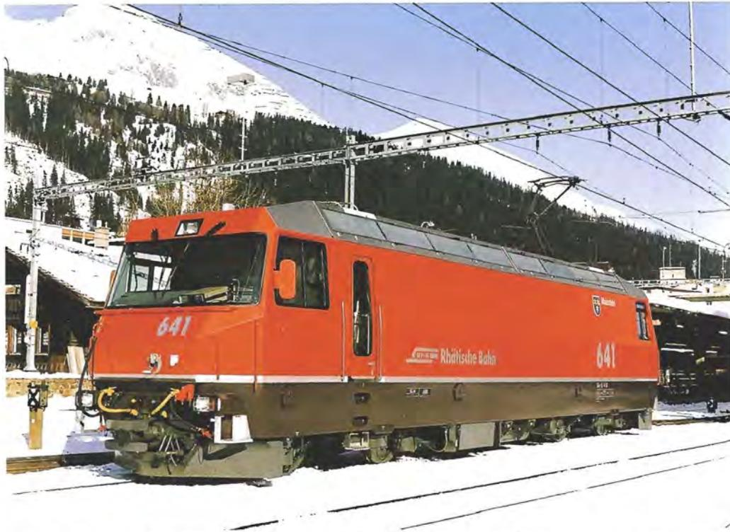
Die 641 war die erste Ge4/4III Ellok der Rhätischen Bahn. Diese 1993 gebauten modernen Loks werden mit Dreiphasen-Wechselstrom betrieben und verfügen über eine Leistung von 3200 kW.
